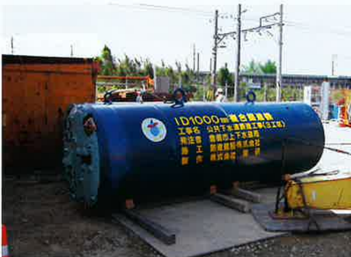
さいちようきろく たっせい きかい 2007年(平成19年) 世界最長記録を達成した機械 うめだだいいちおすいかんせん 梅田第1汚水幹線(大岩・二川地区)において すいしんこうぼう えんちよう きろく 推進工法というトンネル工事で延長1448mを記録
